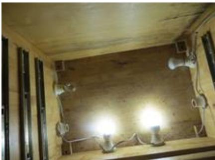
ภาพที่ 9 จากด้านบนของเครื่องอบ#2 จะเห็นส่วนจ่ายความร้อน ไม่จำเป็นต้องเบิดหลอดไฟทั้งหมดเวลาใช้งาน
