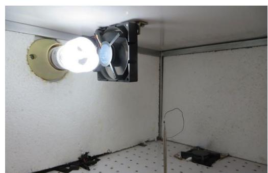
ภาพที่ 16 หลอดไฟ, พัดลม, เครื่องควบคุมอุณหภูมิในเครื่องอบ#3
