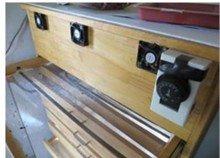
ภาพที่ 11 เครื่องควบคุมอุณหภูมิ และชั้นที่ย้ายชิ้นงานออกได้ของเครื่องอบ#2
