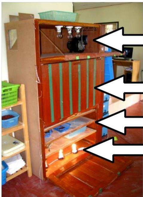
ภาพที่ 3 เครื่องอบ #1 ของeko koc เอเชีย ใช้ไม้ที่หาได้ในพื้นที่ มีหลอดไฟ 4 ขั้นที่ออกแบบเอง พัดลมกรงกระrog และช่องทำความร้อน
