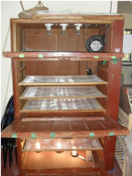
ภาพที่ 6 เครื่องอบ #1 ของeko โค เอเชีย จะเห็นชั้นที่ทำขึ้นเอง หลอดไฟ พัดลมกรอง กระรองเพื่อหมุนเวียนอากาศก่อนจะเพิ่ม ช่องระบายลม ส่วนพัดลมจะพัดลมร้อนจาก บนลงล่างเพื่อช่วยหมุนเวียนลมร้อน
