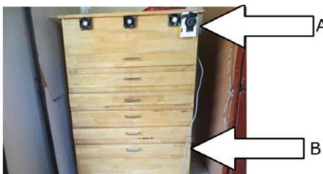
ภาพที่ 8 เครื่องอบ#2 มีที่ปิดส่วนชั้นต่างๆ ไว้ A: เครื่องควบคุมอุณหภูมิและพัดลมระบาย อากาศ, B: ชั้นตากเมล็ด
