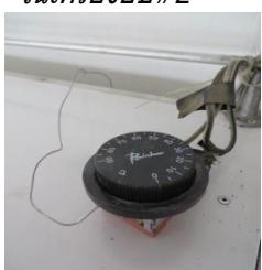
ภาพที่ 14 เครื่องควบคุมอุณหภูมิที่ควบคุมความความร้อนภายในเครื่องอบ#3
