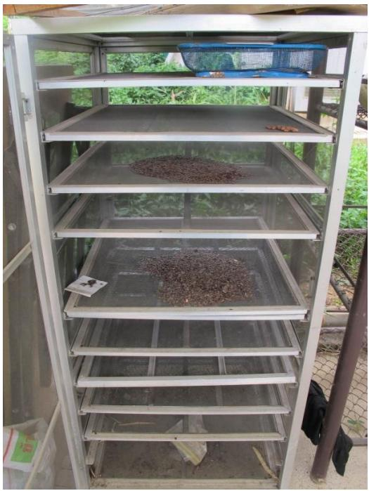
**ภาพที่ 2** ชั้นตากเมล็ด ใช้สำหรับควบคุม สภาพแวดล้อมก่อนนำเมล็ดเข้าเครื่องลดความชื้น
